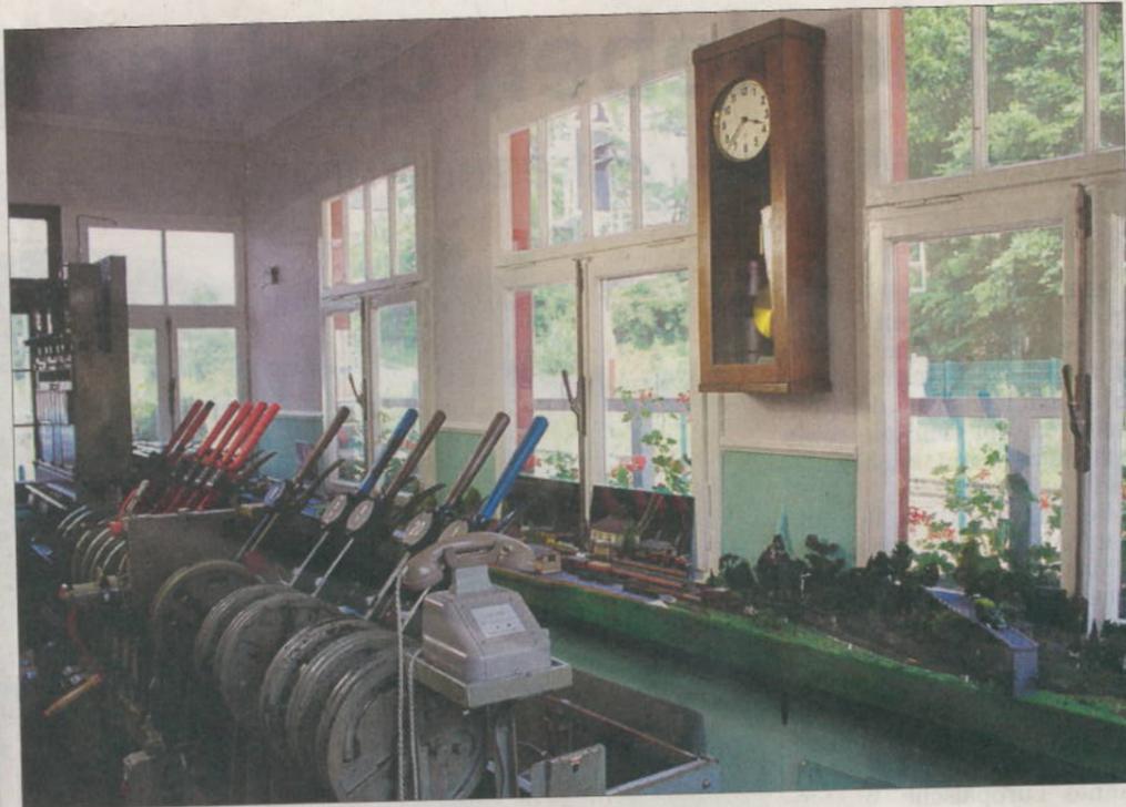
Anfassen und Ausprobieren können Eisenbahnfans ab August die alte Stellwerkstechnik im Witterschlicker Bahnhofsgelände. Alle Hebel sind noch voll funktionsfähig und mit einer Modellbahn verbunden.
